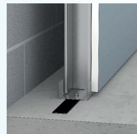
Prévoir une bande résiliente à cellule ouverte en périphérie de la cloison.
